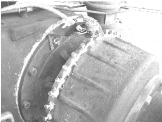
Рисунок 5 - Установка датчика оборотов на балансирах автогрейдера
