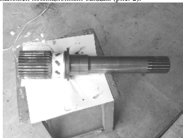
Рисунок 2 - Доработка полуоси автогрейдера
