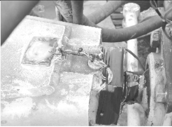
Рисунок 9 - Расположение датчиков на шкворне тяговой рамы
