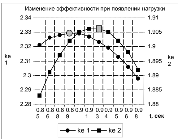
Рисунок 2 – Изменение ресурсоемкости и эффективности запуска электропривода без (1) и с учетом (2) момента сопротивления холостого хода
