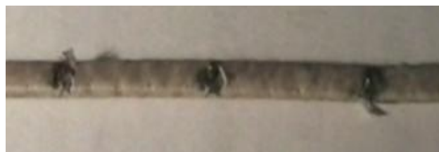
Рисунок 4 – Провод с изоляцией, поврежденной скребковой иглой
