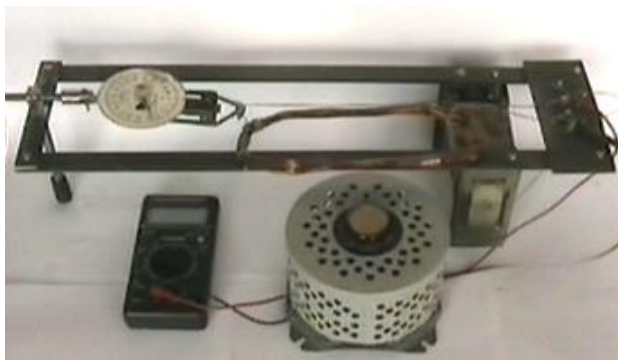
Рисунок 6 – Стенд для исследования изоляции на вибростойкость при непосредственном трении двух проводов: а) схема электрическая; б) фото стенда для катушки; в) фото стенда для секции статора АД
