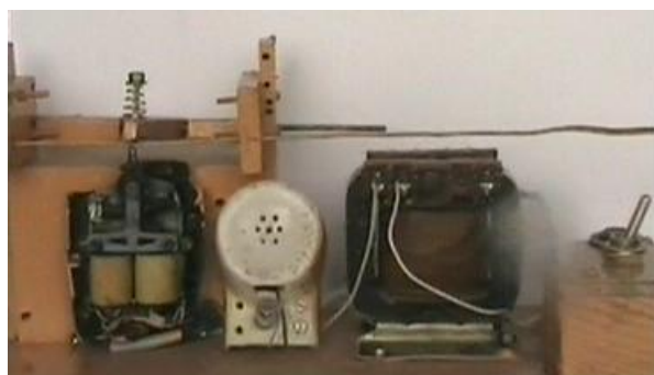
Рисунок 3 – Стенд для исследования изоляции на вибрационную прочность при помощи скребковой иглы: а) схема электрическая; б) фото стенда
