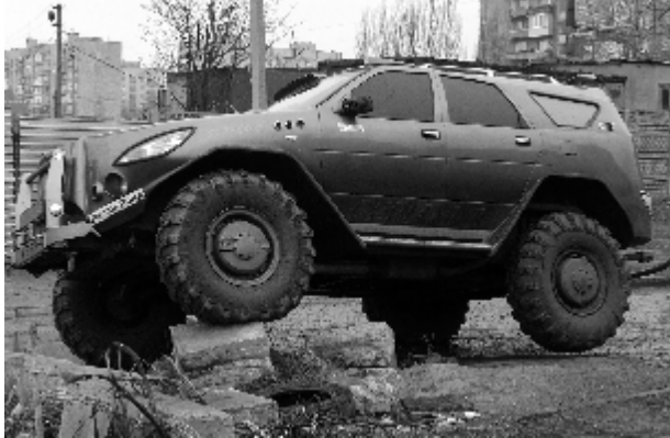
Рисунок 2 – Автомобіль ВЕПР долає бордюри заввишки 500 мм
