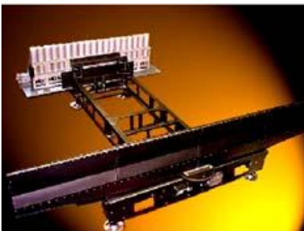
Рисунок 2 – Гамма-телескоп "Фредерик" с линейным позиционно-чувствительным детектором
