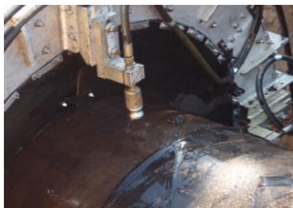
Рисунок 4 – Очищена поверхня із використанням традиційного інструмента
