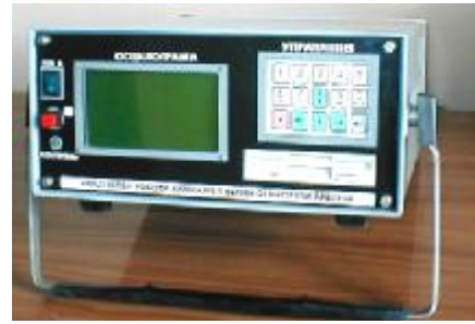
Рисунок 5 – Аналізатор роботи вимикачів АРВВН-4
