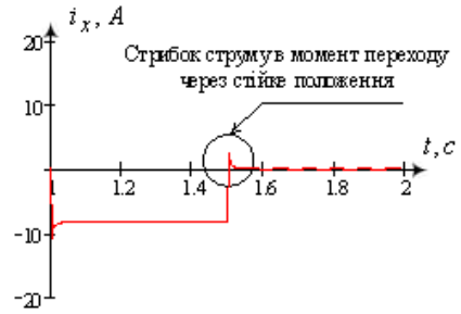
Рисунок 5 – Перехідний процес струму в обмотці крокового двигуна
