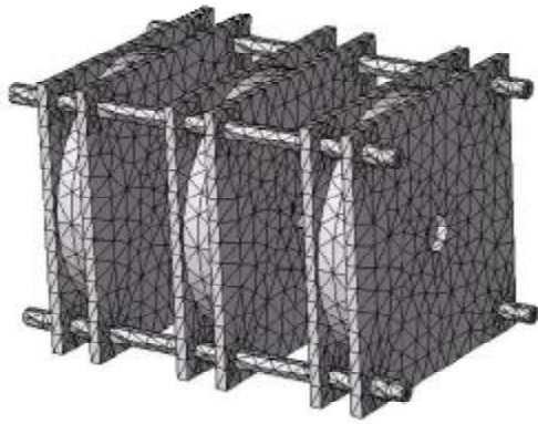
Рисунок 4 – Дискретная модель классической конструкции ИР
