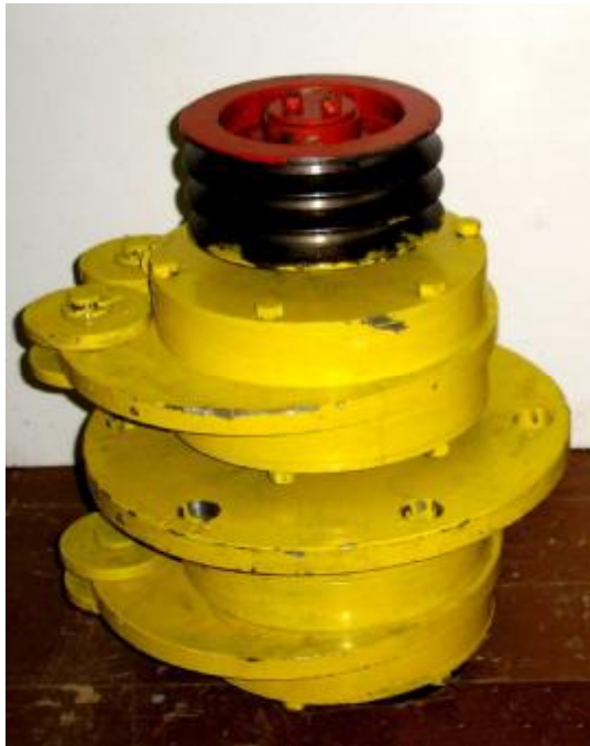
Рисунок 6 –Высокочастотный ВР1-272-105 вибровозбудитель колебаний
