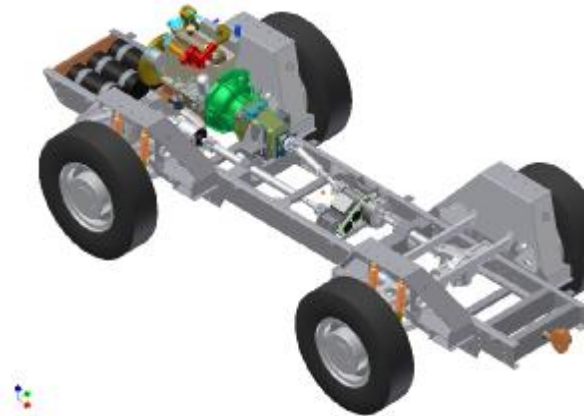
Рисунок 4 – Уніфіковане шасі автомобілів ВЕПР
