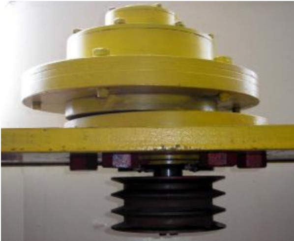
Рисунок 3 – Установка планетарного вибровозбудителя колебаний на опорной плите виброплощадки
