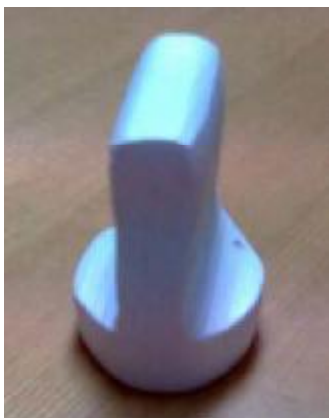
Рисунок 5 – Рефрактор для шпуров щелевого вруба и оконтуривающих
