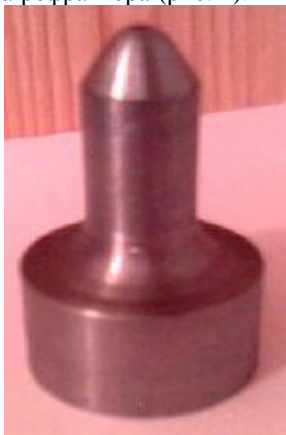
Рисунок 4 – Рефрактор для вспомогательных шпуров
