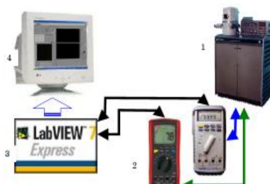
Рисунок 1 – Система реєстрації і обробки результатів 1 - вакуумна камера; 2 – прилади для вимірювання опору; 3 – програмне забезпечення; 4 – дисплей комп'ютера
