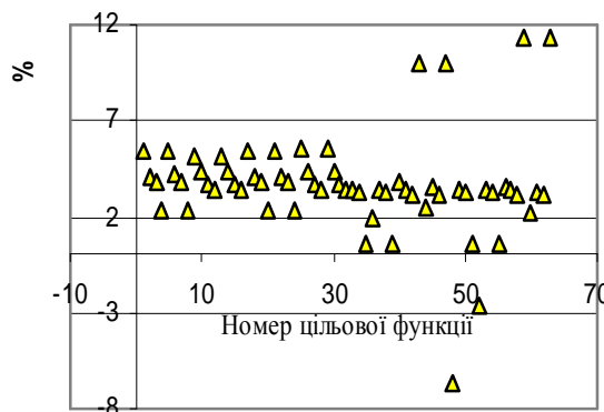
Рисунок 3 – Зміна середньої швидкості в міському їздовому циклі КрАЗ 5131BE при оптимізації за методом симплексу
