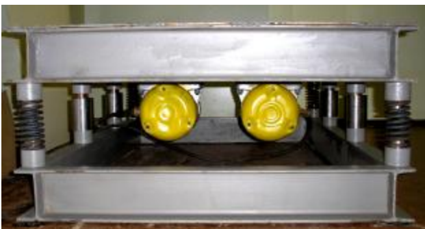
Рисунок 3 – Опытно-промышленный образец виброплощадки с жестко-упругими ограничителями грузоподъемностью 1500 кг
