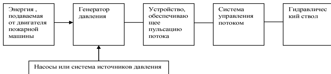
Рисунок 1 – Принципиальная схема системы формирования струйных потоков
