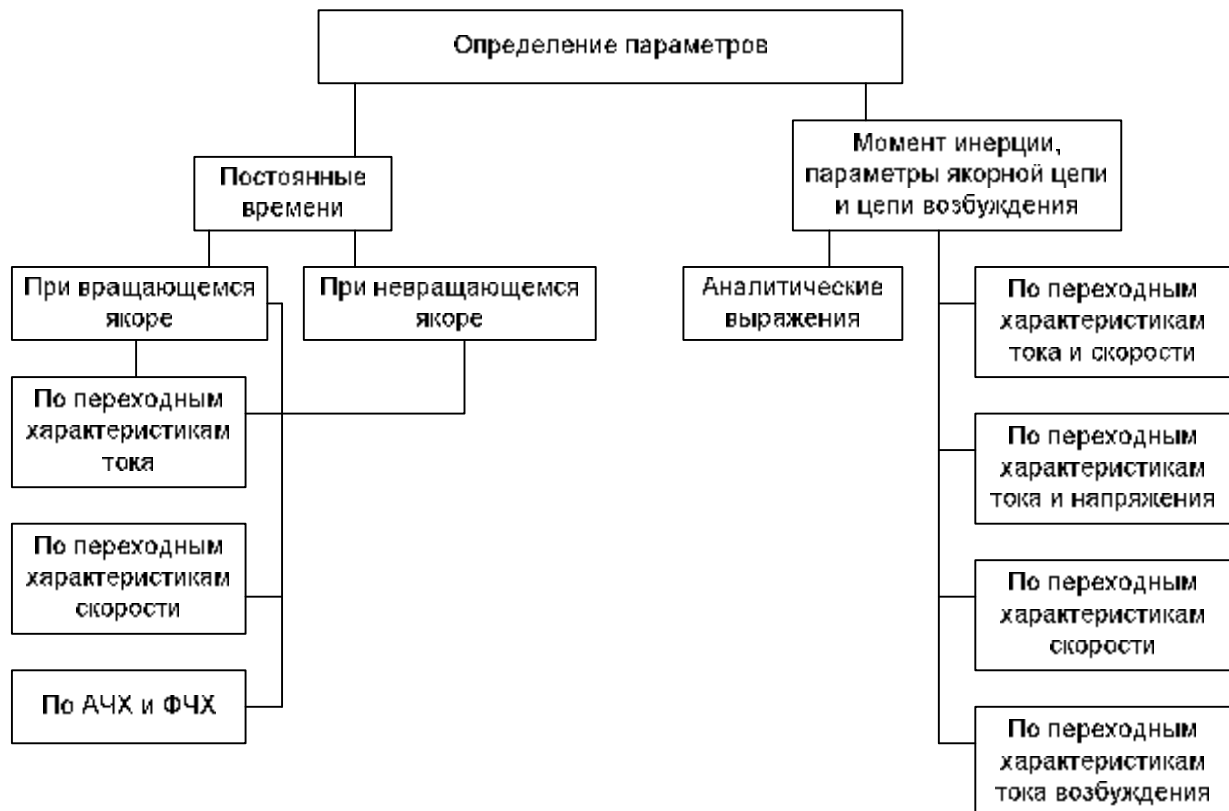
Рисунок 1 – Структурная схема методов определения параметров двигателя постоянного тока независимого возбуждения
