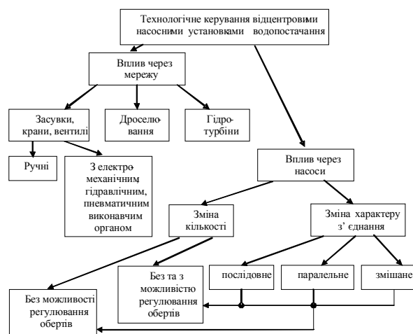
Рисунок 1 – Способи технологічного керування насосними установками системах водопостачання
