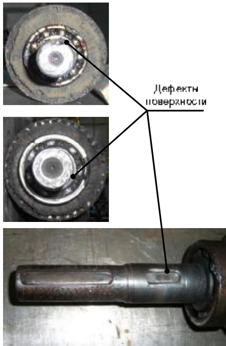
Рисунок 4 – Приклади пошкодження вала АД
