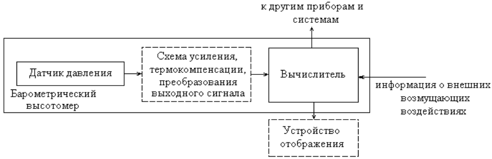
Рисунок 1 – Структурная схема барометрического высотомера.
