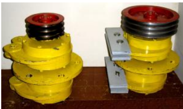
Рисунок 6 – Высокочастотный и низкочастотный ротационные вибровозбудители круговых колебаний
