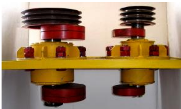
Рисунок 5 – Установка высокочастотного и низкочастотного дебалансных вибровозбудителей круговых колебаний на опорной плите подвижной рамы двухчастотной виброплощадки с пространственными колебаниями грузоподъёмностью 15 тонн
