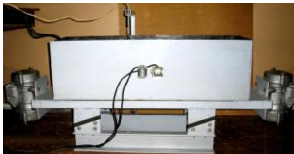
Рисунок 1 – Экспериментальная виброплощадка с пространственными колебаниями
