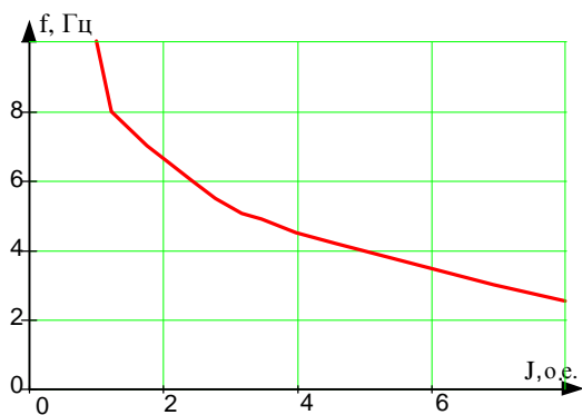
Рисунок 9 – Зависимость частоты колебаний от момента инерции двигателя
