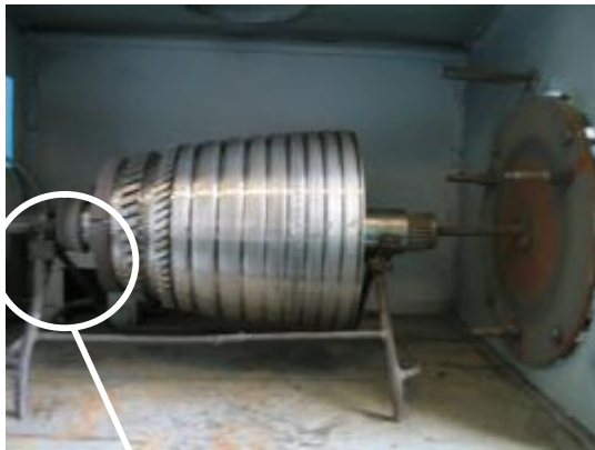
Рисунок 3 – Подготовленная под напыление расточенная поверхность кольца
