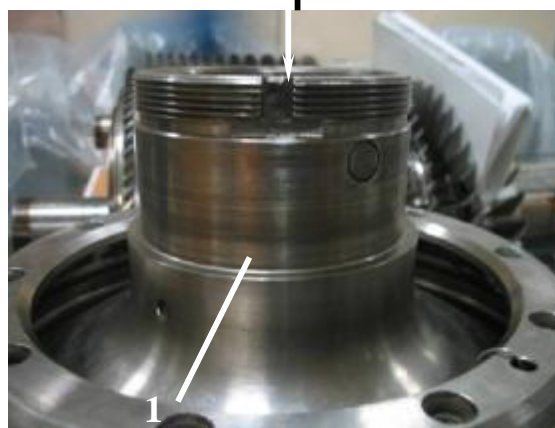
Рисунок 2 – Барабан ротора компрессора вертолетного двигателя: 1 – изнашивающаяся шейка цапфы барабана компрессора
