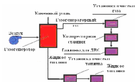
Рисунок 1 – Схема получения и использования продуктов газификации каменного угля
