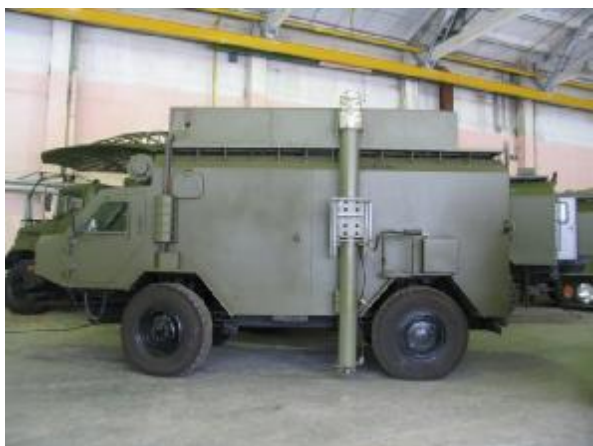
Рисунок 3 – Автомобіль ВЕПР-С «Спеціальний», обладнаний комплексом «Мандат БЕ1»
