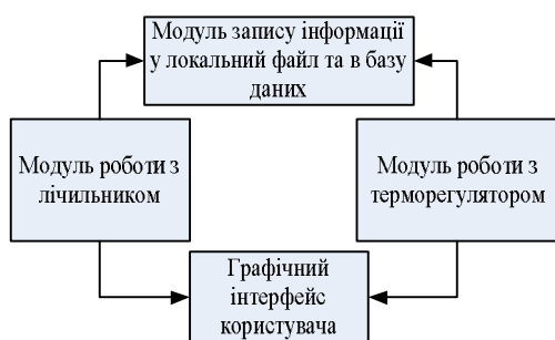
Рисунок 3 – Схема взаємодії блоків програми системи
