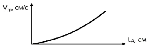
Рисунок 3 – Типова форма залежності інтенсивності коливань ґрунту від розмірів дефектів дорожнього покриття під час руху автотранспорту
